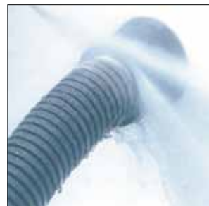
防护性能测试 IEC60529 IP test
