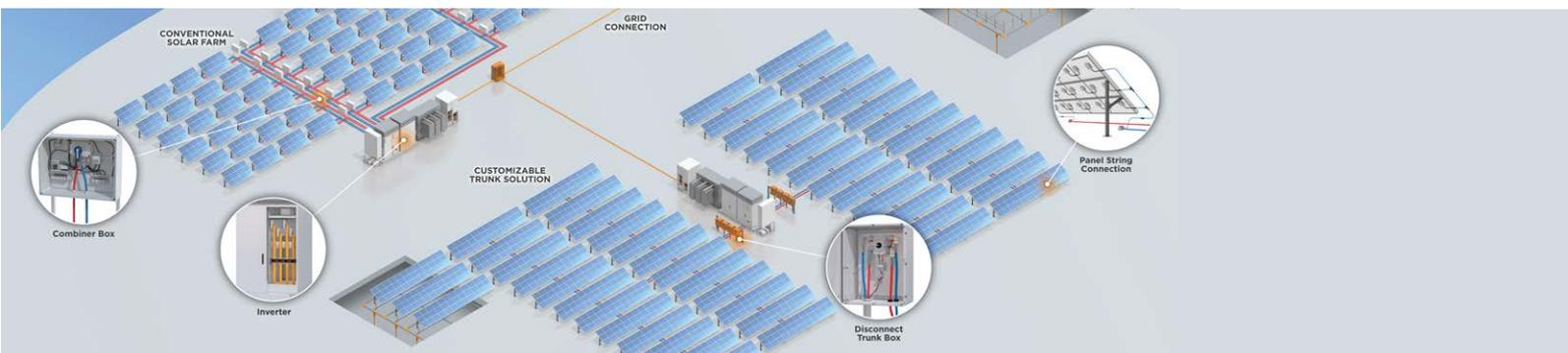
É uma solução TE Connectivity, em parceria com a Proauto Electric, que visa a agilidade na instalação e redução de custos em cabeamento para as usinas fotovoltaicas. Consiste em um cabo tronco no sentido L/O dos trackers, onde é aplicado os conectores perfurantes e os fusíveis em linha com os cabos.
